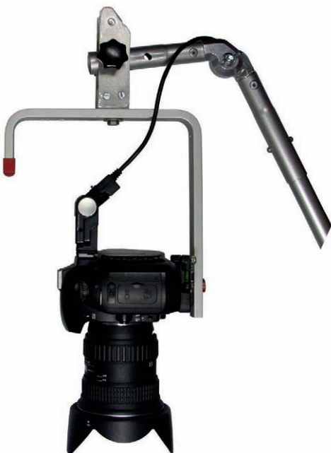
Abb. 7: Kameraaufhängung am Monostativ PhotoMob. Am Fotokran kommt das gleiche Hebelprinzip zum Einsatz. Dadurch lässt sich die Kippbewegung der Kamera ausgleichen (Quelle: R. Weßling, Projekt Meidling/IUF Wien).
